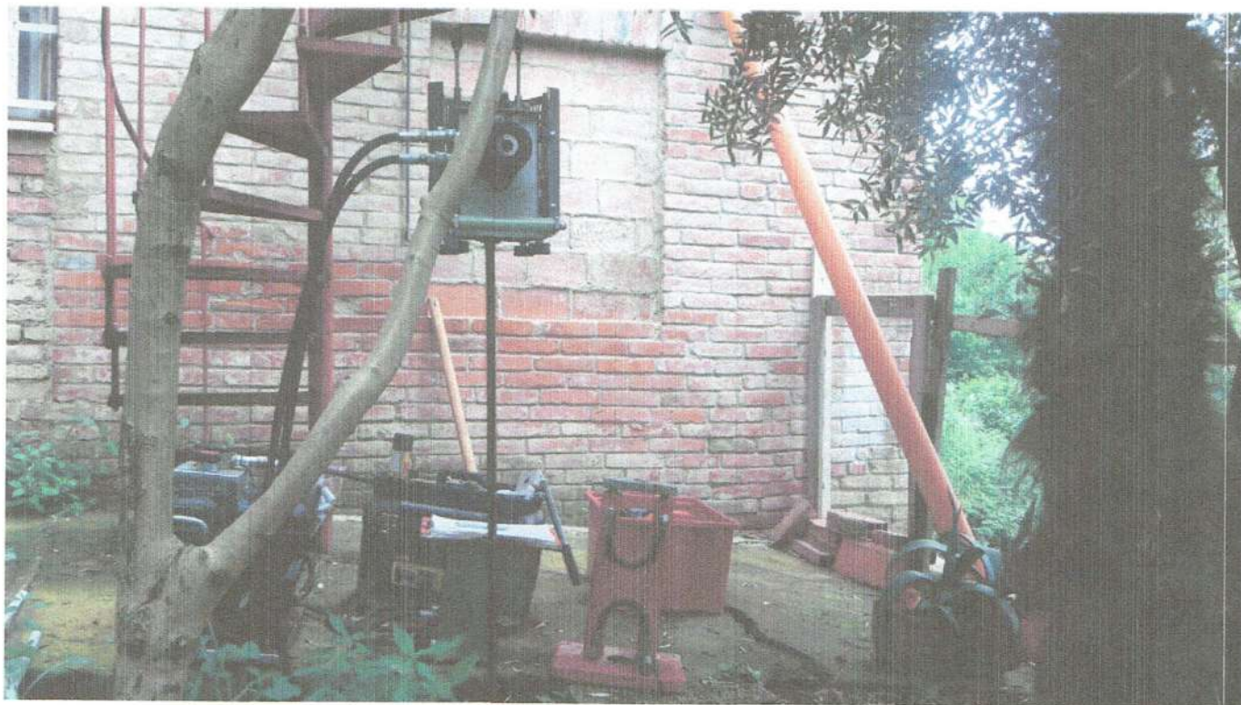
FOTO 1 : Strumentazione utilizzata per l'esecuzione della prova DPM 2.
