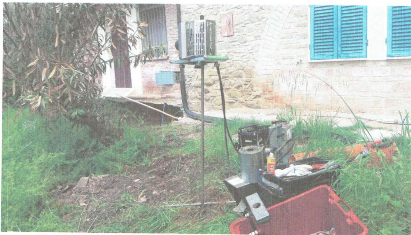
FOTO 1 : Strumentazione utilizzata per l'esecuzione della prova DPM 1.
