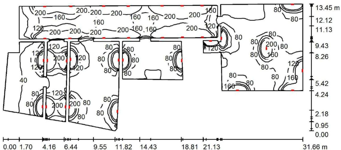
Altezza locale: 3.000 m, Altezza di montaggio: 2.200 m, Fattore di manutenzione: 0.90
