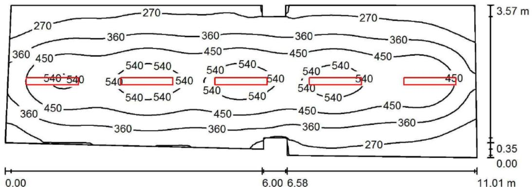
Altezza locale: 3.000 m, Altezza di montaggio: 2.700 m, Fattore di manutenzione: 0.90
