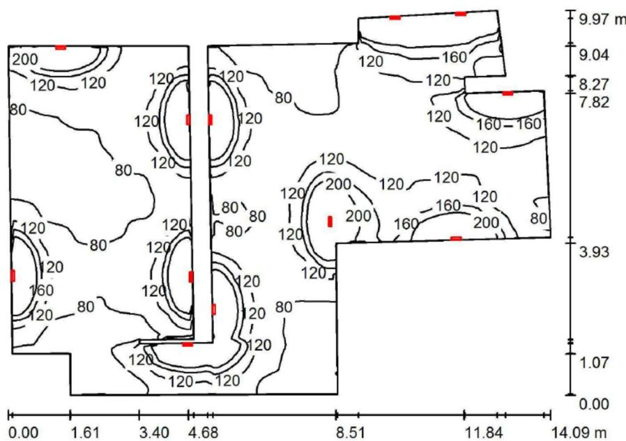
Altezza locale: 3.000 m, Altezza di montaggio: 2.200 m, Fattore di manutenzione: 0.90
