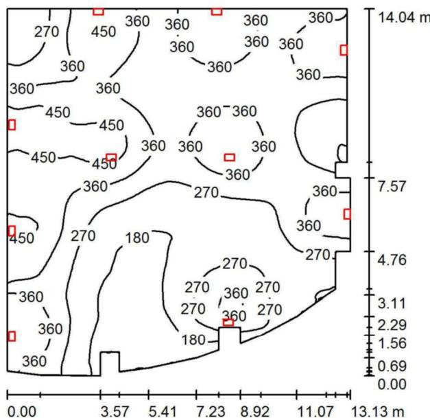
Altezza locale: 3.000 m, Altezza di montaggio: 2.000 m, Fattore di manutenzione: 0.90
