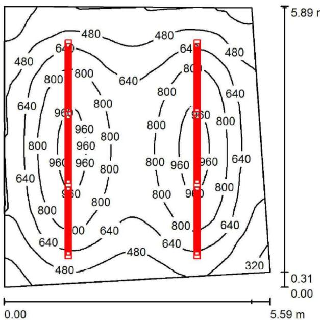
Altezza locale: 3.000 m, Altezza di montaggio: 2.500 m, Fattore di manutenzione: 0.90
