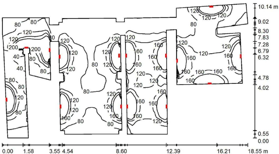
Altezza locale: 3.000 m, Altezza di montaggio: 2.200 m, Fattore di manutenzione: 0.90
