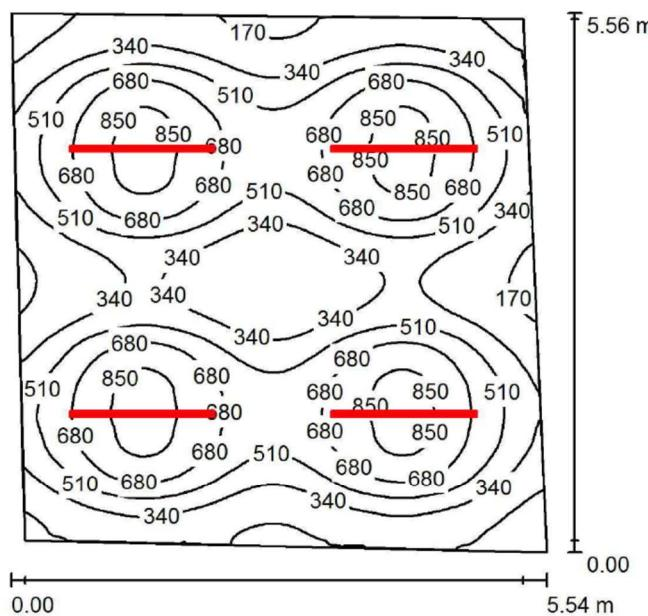
Altezza locale: 3.000 m, Altezza di montaggio: 2.500 m, Fattore di manutenzione: 0.90
