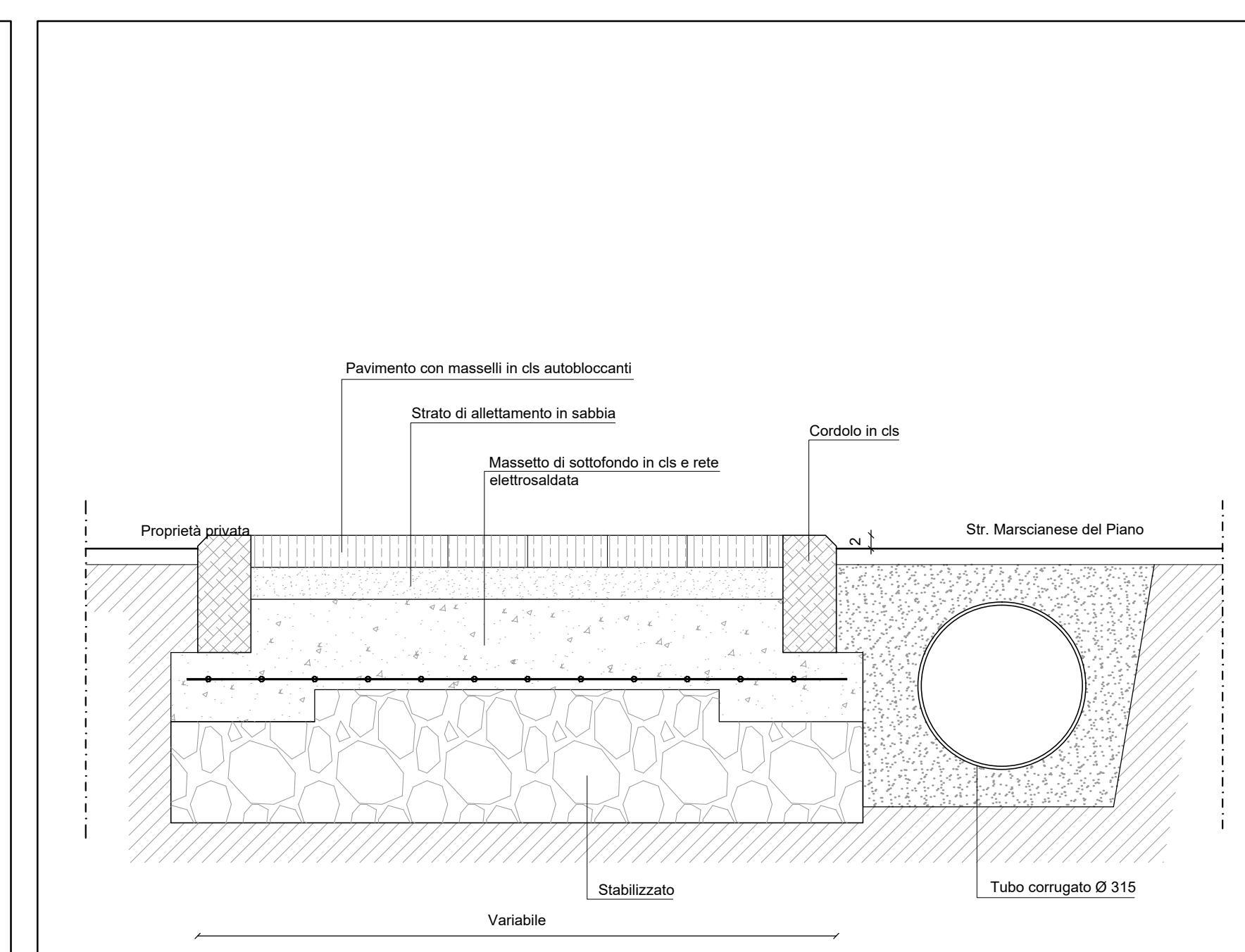
SEZIONE B-B - MARCIAPIEDE ESISTENTE IN CORRISPONDENZA DEGLI ACCESSI CARRABILI SCALA 1:10
