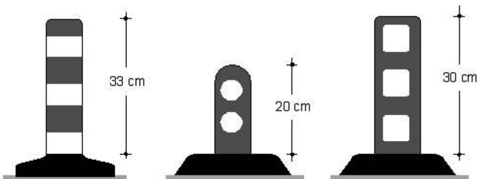
Gli elementi prefabbricati per salvagenti pedonali e **delimitatori di corsia** possono essere realizzati in calcestruzzo, costituiti da sezioni componibili mediante appositi incastri. Essi devono essere impiegati solo
