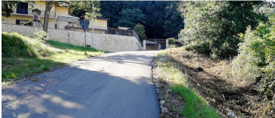
Via Lazzaro Spallanzani: la vasca di decantazione delle acque del bacino B1 verrà realizzata sulla parte destra della foto e da qui partirà il primo tratto della nuova fognatura in PVC 315.
