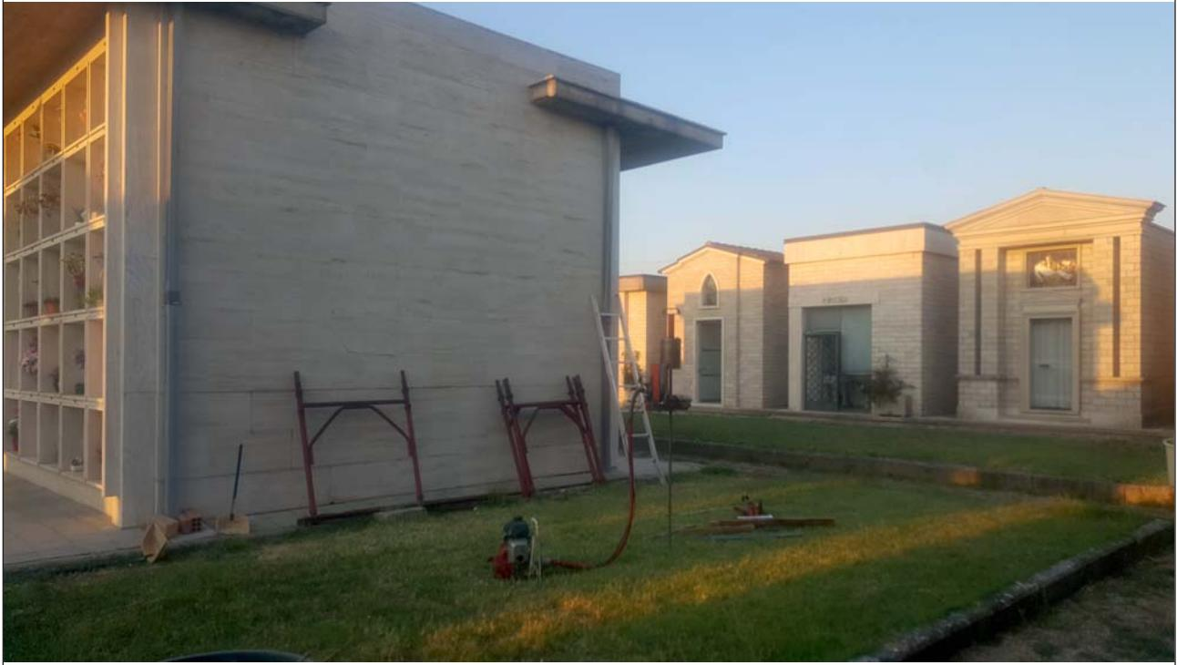
**PROVA PENETROMETRICA DINAMICA DPM**
