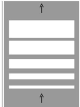
Sulla base delle indicazioni progettuali ovvero della Direzione Lavori, i sistemi di rallentamento ad **effetto acustico** saranno realizzati mediante irruvidimento della pavimentazione stradale ottenuta con la scarificazione o incisione superficiale della stessa o con l'applicazione di strati sottili di materiale in rilievo in aderenza, eventualmente integrato con dispositivi rifrangenti. Tali dispositivi possono anche determinare effetti vibratori di limitata intensità.
