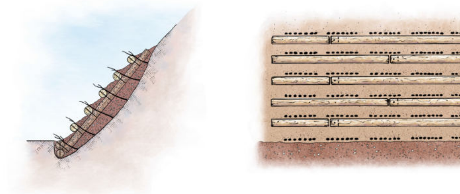
(c) Completamento della struttura con posa in opera di materiale vegetativo vivo e riempimento con materiale inerte
