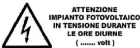
Poiché il generatore fotovoltaico è installato sulla copertura, detta segnaletica sarà installata in corrispondenza di tutti i varchi di accesso del fabbricato.
