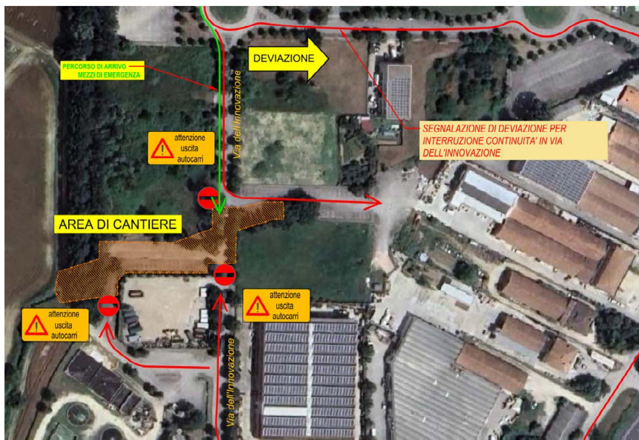
Figura 2 - istituzione dell'area di cantiere e modifica al traffico locale
